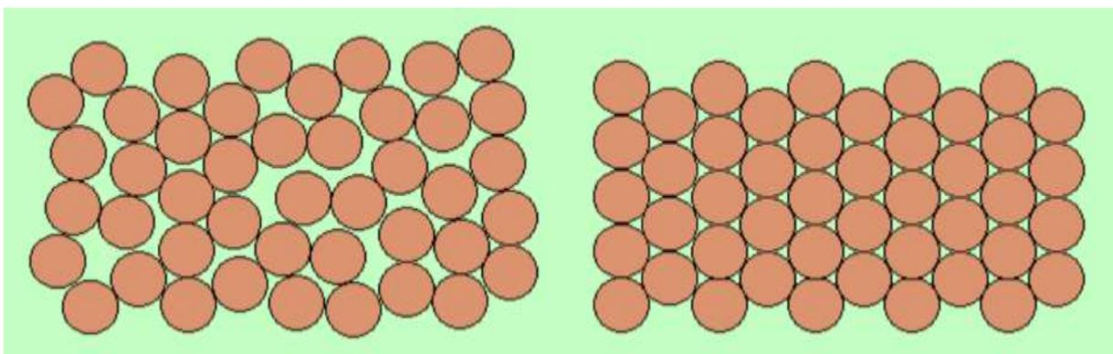
Abb.3: Die Nahordnung in Flüssigkeiten (links) im Vergleich zur Kristallstruktur (rechts).
