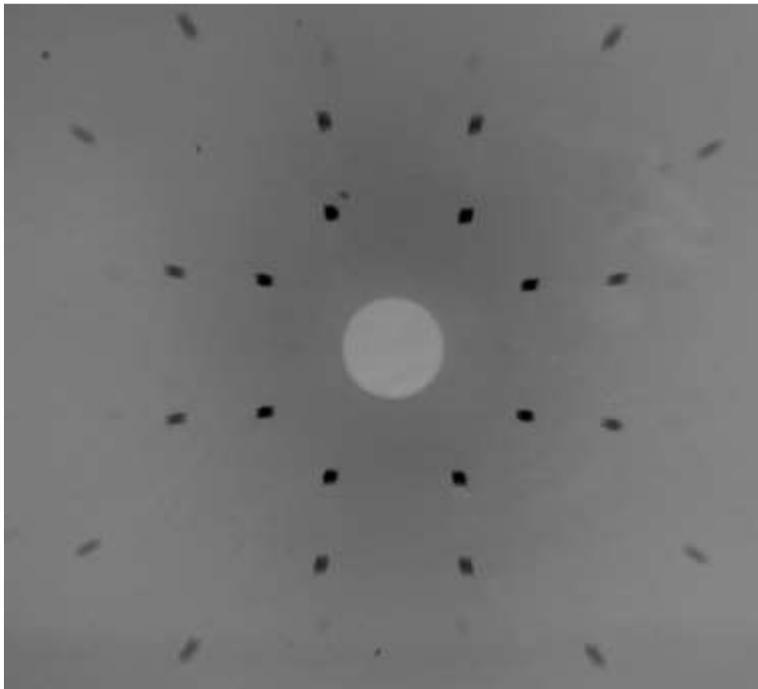
Abb.2: “Weiße” Synchrotronstrahlung generiert diese Laue Aufnahme von Diamant. Die einlaufende Strahlung ist in Richtung einer der vier Symmetrieachsen der Tetraeder Struktur des Diamants ausgerichtet.<sup>3</sup>
