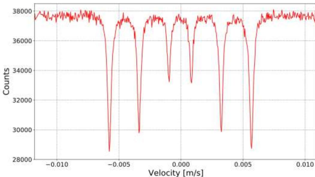
Abb. 1: Mößbauer Absorptionsspektrum von natürlichem Eisen bei Zimmertemperatur als Funktion der Geschwindigkeit der Quelle in m/s. Die Anzahl der Ereignisse entspricht der Zählrate =Counts. Die Geschwindigkeit 0.001 m/s entspricht einer Energieverschiebung von  $4.8 \cdot 10^{-8} \text{ eV}$ . Die natürliche Linienbreite ist  $4.66 \cdot 10^{-9} \text{ eV}$ . Die Abbildung ist von <https://commons.wikimedia.org/wiki/File:M%C3%B6ssbauerSpectrum57Fe.svg> übernommen.
